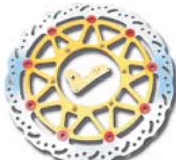
EBC Supermotard Contour Rotor Kit ("SM" Prefix on Part #)
